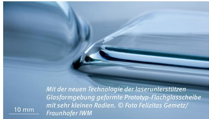
Mit der neuen Technologie der laserunterstützten Glasformgebung geformte Prototyp-Flachglasscheibe mit sehr kleinen Radien. © Foto Felizitas Gemetz/Fraunhofer IWM
