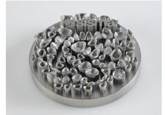
*Sisma Group – Der Zahnarzt scannt. Dentallabore übersetzen die 3D-Daten in Druckdateien. Und 3D-Drucker fertigen individuell an Patienten angepasste Unterbauten für deren Zahnersatz. Foto: Sisma Group*
