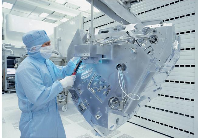
*ZEISS – Schrittmacher des Moor'schen Gesetzes: Hoch präzise Lithographie-Optiken von Zeiss sollen künftig Wafer mit extremem, ultraviolettem Licht der Wellenlänge 13,5 Nanometer belichten. Foto: ZEISS*
